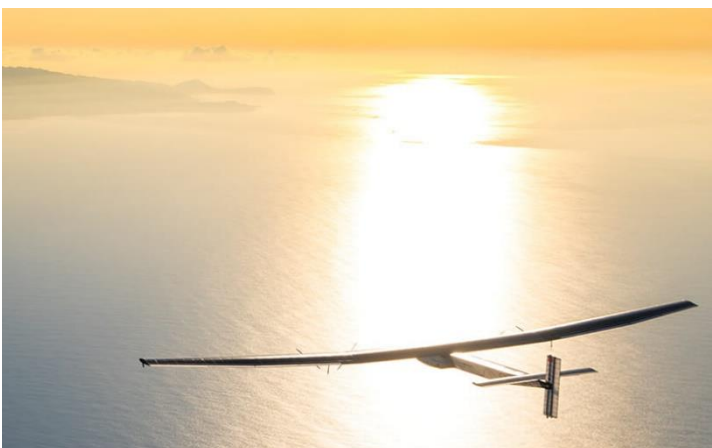
Solar Impulse 2 avec une envergure d'environ 70 mètres possède 17 000 cellules photovoltaïques pour capter l'énergie solaire.
